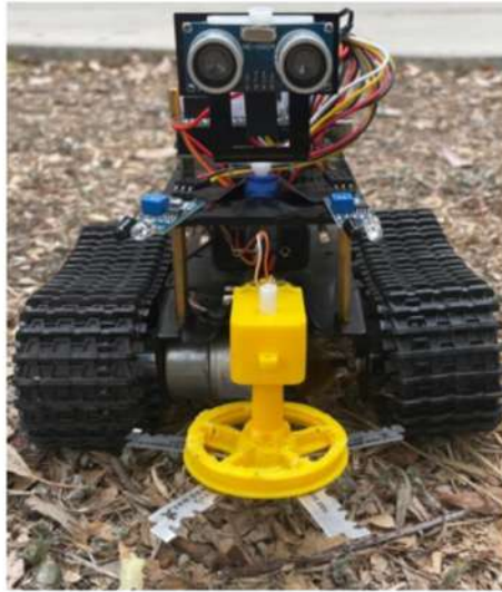
Imagen 4. Talos, desbrozadora autónoma
